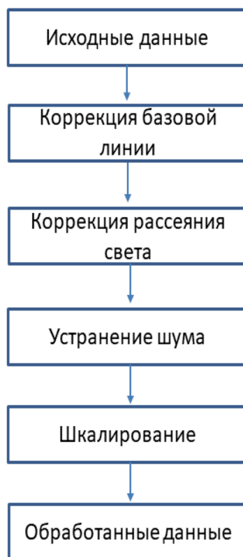
Рис. 3.2. Возможная стратегия предварительной обработки ИК спектроскопических данных. Отдельные этапы могут быть пропущены, или изменены в зависимости от свойств данных и цели исследования.
